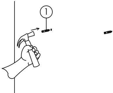
INSERT WALL PLUG INTO THE HOLE BY HAMMER
