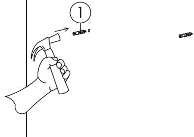
INSERT WALL PLUG INTO THE HOLE BY HAMMER
